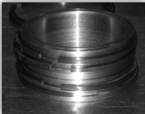
Рисунок 9. Лабиринтные уплотнения и сегменты.
