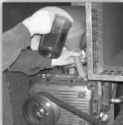
Рисунок 40. Заполнение маслом картера.
