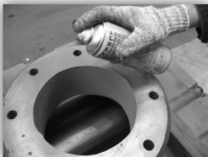
Рисунок 45. Внутренняя чистка центральной части воздуходувки.
