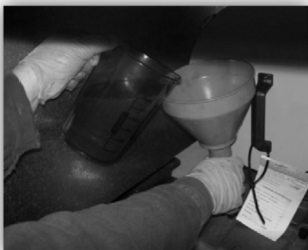
Рисунок 40. Заполнение маслом картера.
